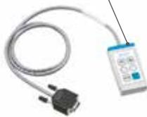
Connexion du clavier de configuration au Vigi
