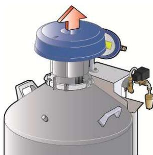
Figure 8-1 : ouverture ou fermeture du bouchon
